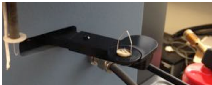
Figura 5.8. Cadinho onde são colocadas as amostras no equipamento TGA Q500.
