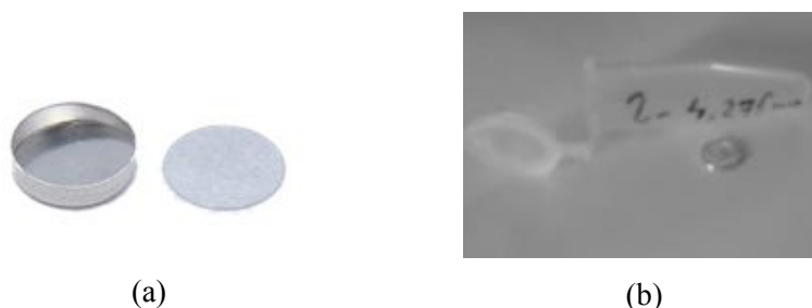
Figura 5.6. (a) Suporte metálico para preparação das amostras para ensaio de DSC. (b) amostra pronta para ensaio em comparação às dimensões de um tubo tipo Eppendorf.
