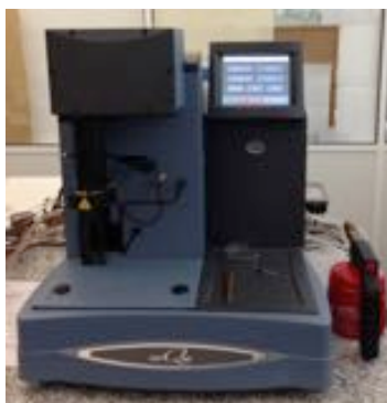
Figura 5.7. Equipamento TGA Q500 com software QSeries (TA Instruments, EUA).
